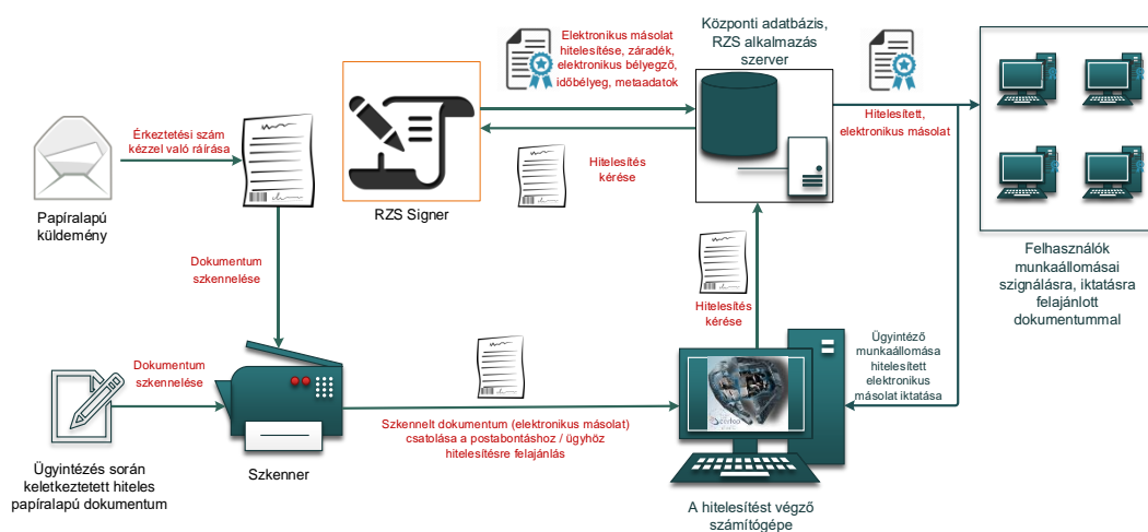
1. ábra: Papíralapú iratról hiteles elektronikus másolat készítésének rendszerszintű feldolgozási folyamata
